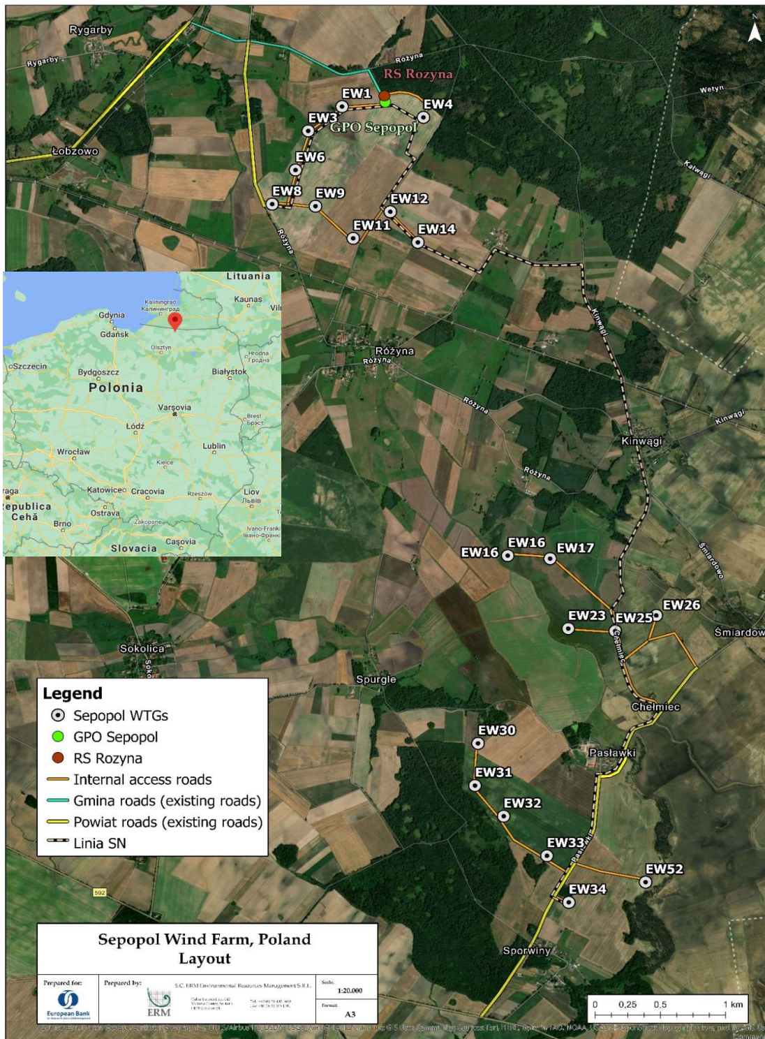
Rys. 2-3 Rozmieszczenie urządzeń energetyki wiatrowej Sępopol
